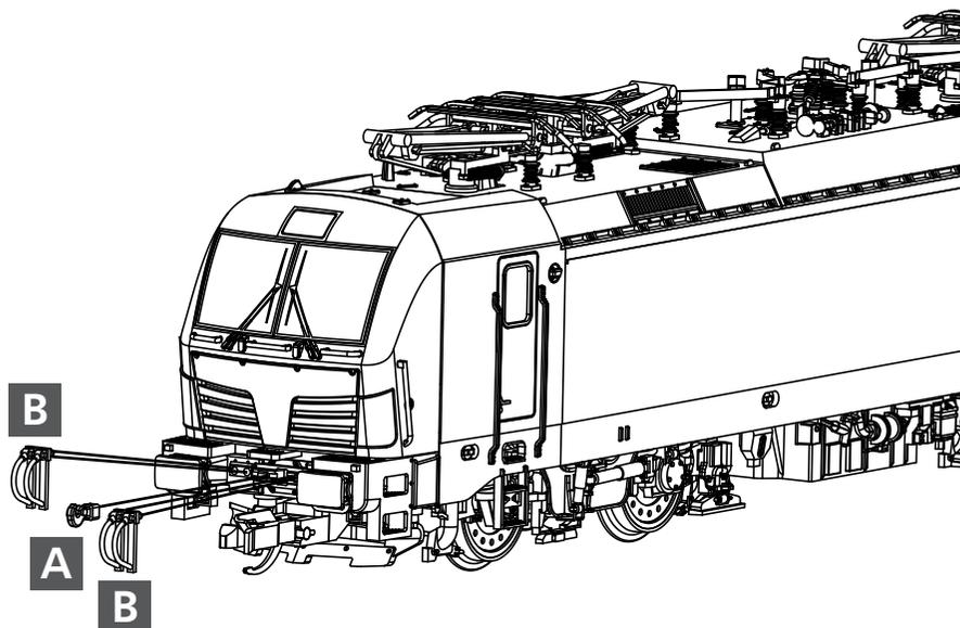
(DE) Beim Betriebseinsatz ist zu beachten, dass die Bremsschläuche die Funktion der Kupplungsdeichsel behindern.
