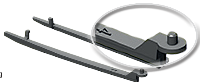
CAD-Abb. zeigt geänderte Weichenzunge
